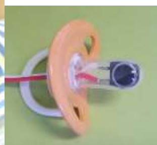
◆ピエゾセンサー、光電センサー、ニューマチックセンサー (指の取り付け例) ◆おしゃぶりスイッチ
